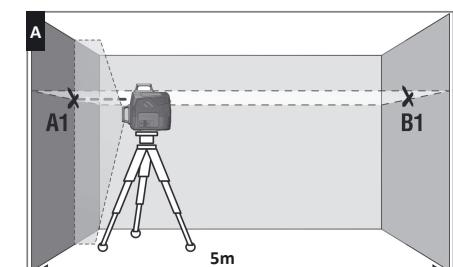
2. Obrócić urządzenie o 90°, zmierzyć odchylenie osi wiązki od B1 (zob. rysunek B). Jeśli odchylenie przekracza 1,5 mm - skontaktować się z centrum serwisowym.
