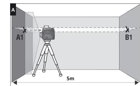
2. Ruotare il dispositivo di 90°, misurare la deviazione dell'asse del raggio dal segno B1 (vedi Fig.B). Se la deviazione supera 1,5 mm, contattare il centro di assistenza.
