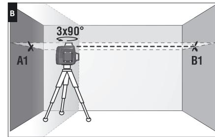
3. Повторите пункт 2 еще 2 раза, поворачивая прибор в одном направлении.
