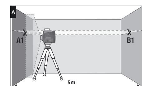
2. Faites pivoter l'appareil de 90°, mesurez l'écart de l'axe du faisceau par rapport au repère B1 (voir fig. B). Si l'écart dépasse 1,5 mm, contactez le centre de service.
