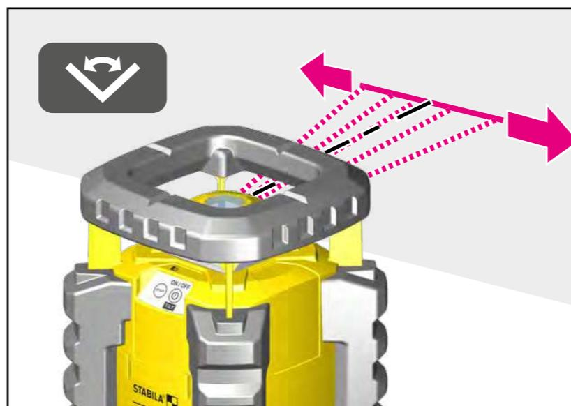
После последующего переключения на режим сканирования или секторный режим лазерный луч совпадает с настроенным положением точечного лазера. Направление сектора лазера или лазерной линии в режиме сканирования можно точно определить заранее.
