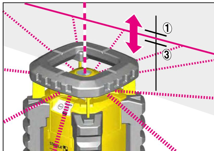
Поверните лазер на  $90^\circ$ , чтобы ось Y указывала на стену. Если центр лазерной линии не совпадает с центром, отмеченным при калибровке осей X, следует откалибровать ось Y.
