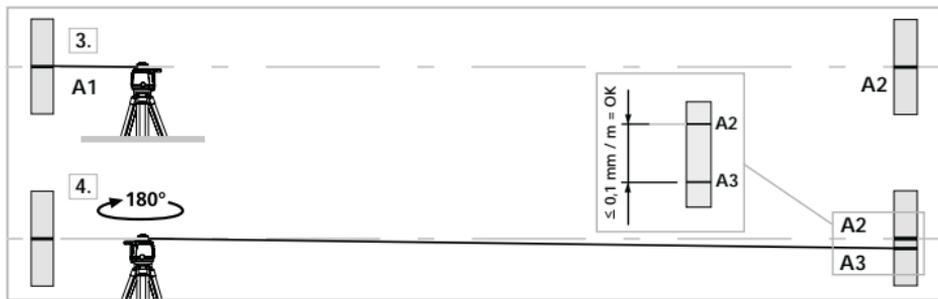
**!** Нове калібрування потрібно, якщо на осі X, Y або Z точки A2 і A3 розташовані на відстані більш ніж 0,1 мм на 1 м одна від одної.
