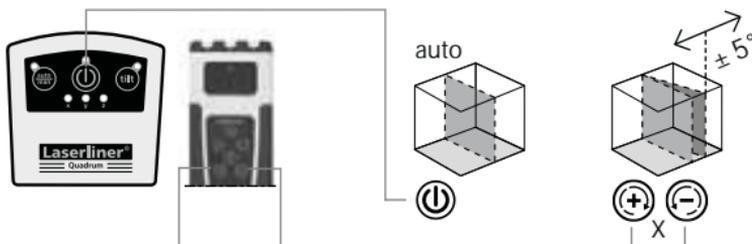
**!** Якщо блимає СД-індикатор автоматичного/ручного режимів, досягнута межа максимальної компенсації ( $5^\circ$ ). Тоді встановіть прилад горизонтально та вимкніть й знову увімкніть його.
