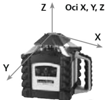
**!** Регулярно перевіряйте юстирування перед використанням, після транспортування та тривалого зберігання. При цьому завжди перевіряйте всі осі.
