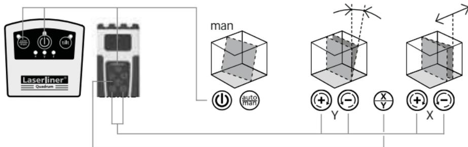
**!** Сразу после достижения максимального диапазона угла наклона 5° лазер останавливается и начинает мигать. После этого следует уменьшить угол наклона.
